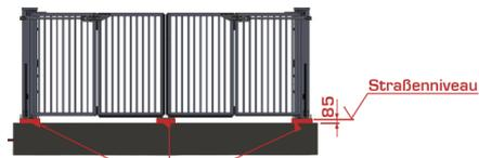
Füllen Sie nach dem Aufbau den Raum zwischen dem Fundamentblock und der Säulengrundplatte Grundplatte bis 1 cm unter die Grundplatte.
